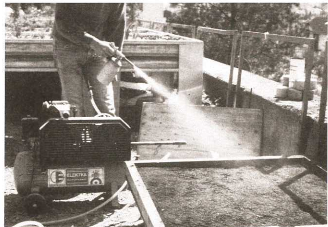
Abbildung 2: Ausrüstung für die Naßsaat, bestehend aus Kompressor und Sprühpistole
